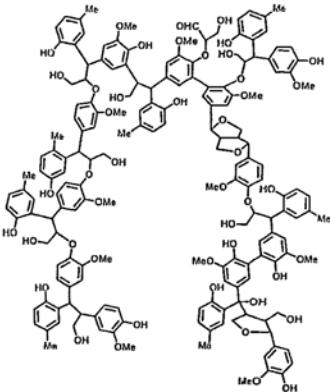
も大阪市工研で開発されている。リグノフェノールに低分子量ノボラックを20%添加剤として加え、ジアゾナフトキノンを感光剤とした材料は市販の印刷原版用フォトレジスト材と同等の感光性能をもっている。プリント配線用フォトレジストとしての使用も可能であり、耐エッチング性に優れ、30μm幅までの解像度が得られるという。
