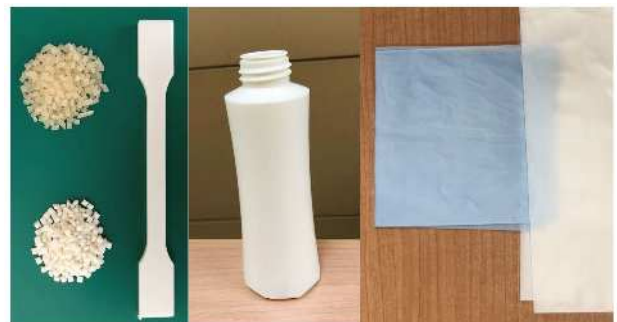
図3 デンプンペレット、MBBPコンパウンド、ダンベル片（左）、ボトル（中）、フィルム（右）
