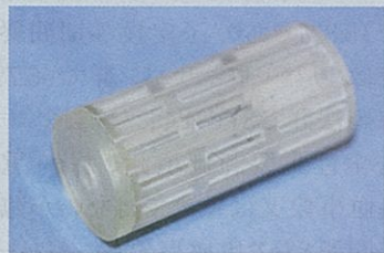
〈図6〉3Dプリンターを用いて作製したバイオバルブ心臓弁作製用の「型」
