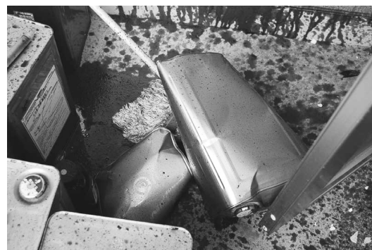
写真2 破裂し、底の抜けた缶
