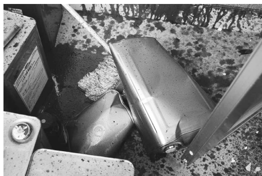
写真 2 破裂し、底の抜けた缶
