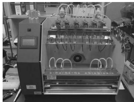
写真 5. PCB 分析前処理装置 (三浦工業社製)
