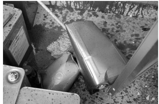
写真2 破裂し、底の抜けた缶
